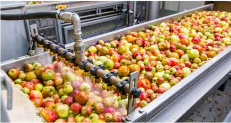
Mittels Wasserdüsen werden die Äpfel abgespült, bevor sie in einer Mühle zur Maisch zerkleinert und zum Pressprozess geführt werden.
