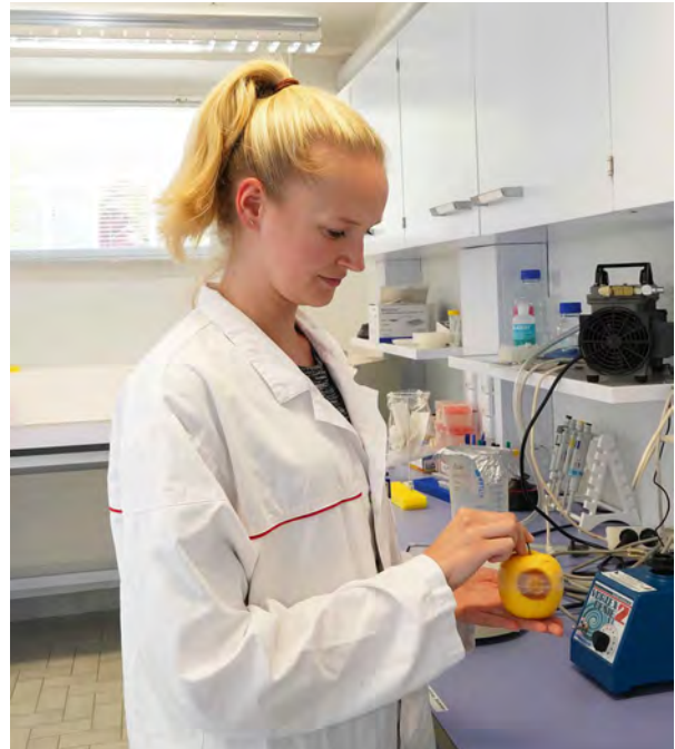
Tausende Äpfel der Refpop-Sammlung werden im Labor unter kontrollierten Bedingungen mit dem Erreger der Lentizellenfäule inokuliert, um die jeweilige Resistenz auf die Krankheit zu testen.
