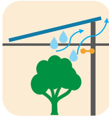
Des ouvertures au sommet de la structure permettent une ventilation passive par un effet de "cheminée".
