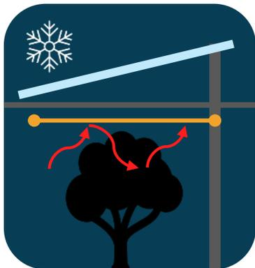
La couche optique se déploie automatiquement la nuit pour garder les cultures au chaud et les protéger du gel.
