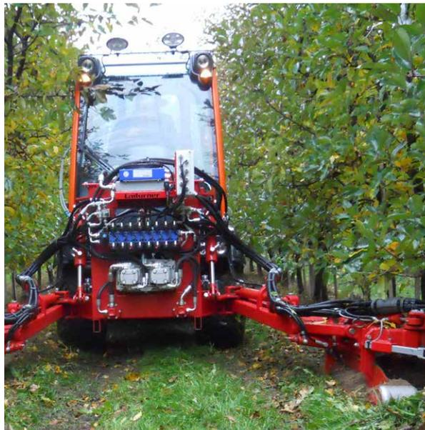
Die Baumstreifen werden mit einem einarmigen Ladurner-Unterstockgerät bearbeitet. Mit einem zweiarmigen Gerät (wie abgebildet) wären sie doppelt so schnell.
