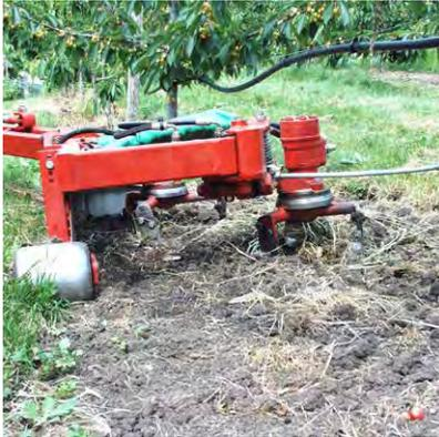
Photo 1 : La sarcluse Ladurner ouvre le sol et mobilise l'azote.
