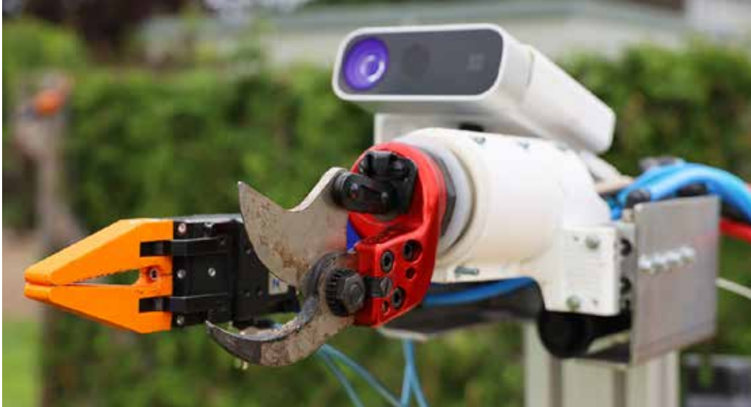
Das von der Forschungsgruppe ACRO (Automatisierung, Computer Vision und Robotik) der KU Löwen entwickelte Robotermodul für den Schnitt.
