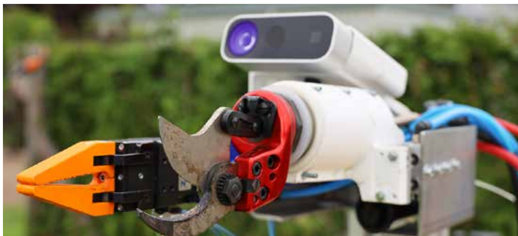
Le module robotisé de taille des arbres mis au point par le groupe de chercheurs ACRO (automation, computer, vision et robotique) de la KU Leuven.
