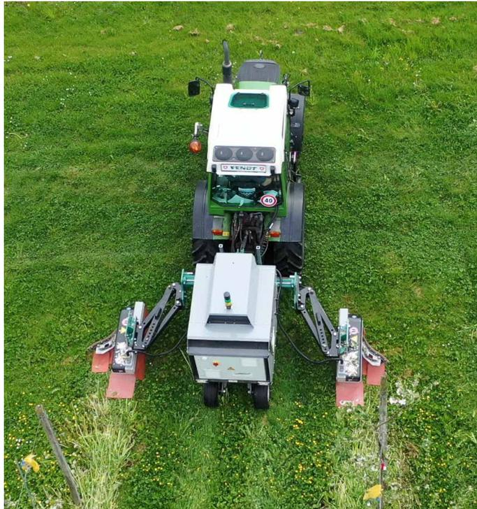
Das Gerät für die elektrothermische Unkrautbekämpfung in den Baumstreifen, welches den Obstproduzenten als Dienstleistung in Lohnarbeit zur Verfügung steht: Damit entfallen für den Betrieb die Anschaffung des Geräts sowie administrativer Aufwand.
