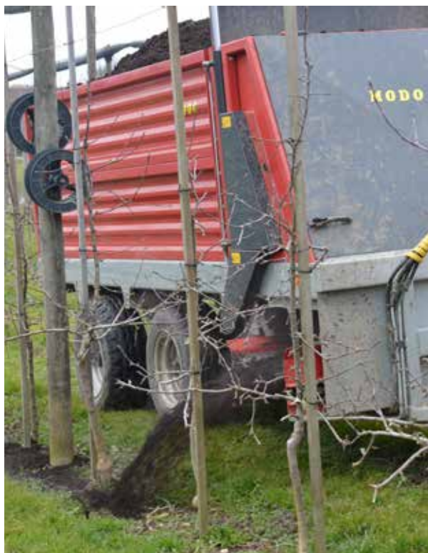
Respectueux du sol et rationnel : Dans ses vergers, l'exploitant utilise une épandeuse attelée qui épand le compost en dirigé sur les rangs d'arbres à l'aide d'un tapis transversal. Cette épandeuse permet un épandage finement dosé et constant du compost.
