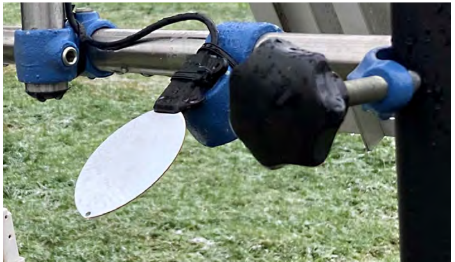
Mit dem Blattnässe-Sensor erhalten auch Obstproduzenten präzise und zuverlässige Messungen ihrer Anbauflächen. Diese Daten werden direkt an die App übermittelt und tragen durch ein konfigurierbares Warnsystem zur Bekämpfung von Krankheiten, zur Planung von Pflanzenschutzbehandlungen und zum Frostschutz bei.
