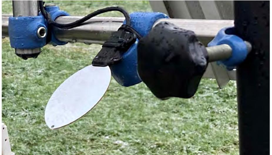
Grâce au capteur de mouillage foliaire, les producteurs de fruits obtiennent des mesurages précis et fiables sur les surfaces cultivées. Ces données sont transmises directement à l'appli et contribuent à travers un système d'alerte configurable à la lutte contre les maladies, la planification des traitements phytosanitaires et la protection antigel.
