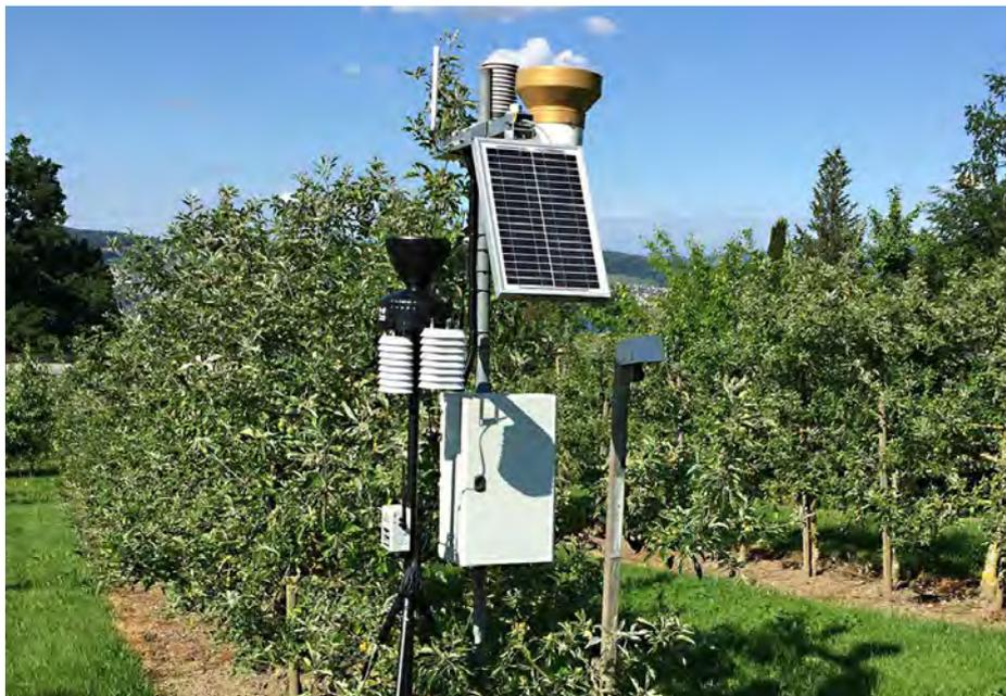
Les données collectées par les stations météo permettent à l'exploitation d'effectuer les traitements et les arrosages avec précision et au besoin, et de protéger les cultures en correspondance.
