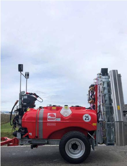
Lidar-Sensoren bei der Spritze.
