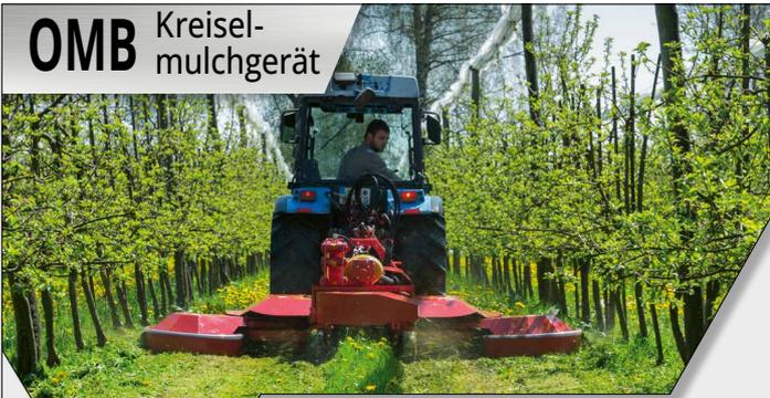
Das neue humus Kreiselmulchgerät OMB speziell zur Kultivierung des Blühstreifen in Obstanlagen.
