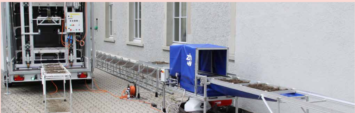
Pilotanlage mit UV-C-Belichtungseinheit und Paternoster-Gondeln links sowie mobiler Sprühanlage rechts im Bild.
