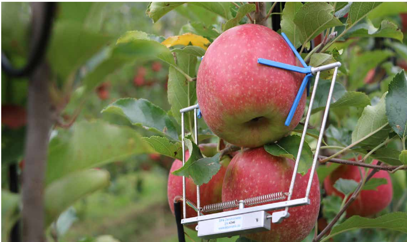
Mit Dendrometern wird das Fruchtwachstum gemessen.
