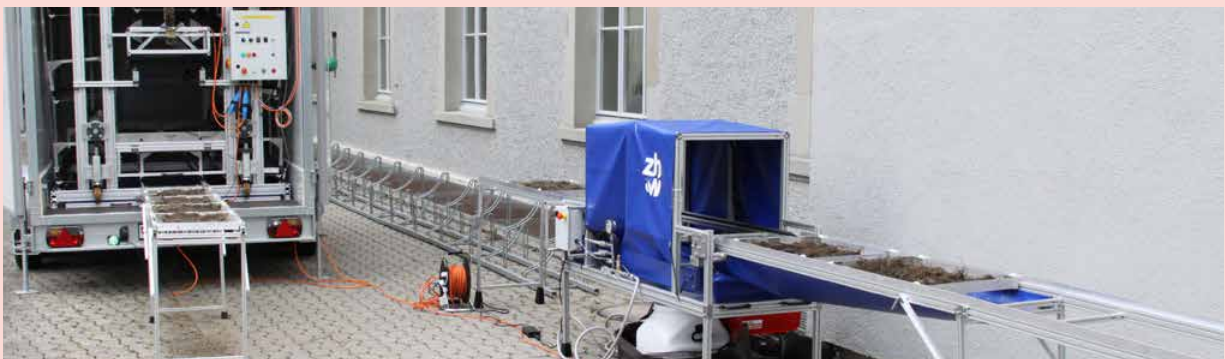
Installation pilote avec unité d'irradiation UV-C et nacelles Paternoster à gauche, ainsi qu'un système de pulvérisation mobile à droite sur la photo.
